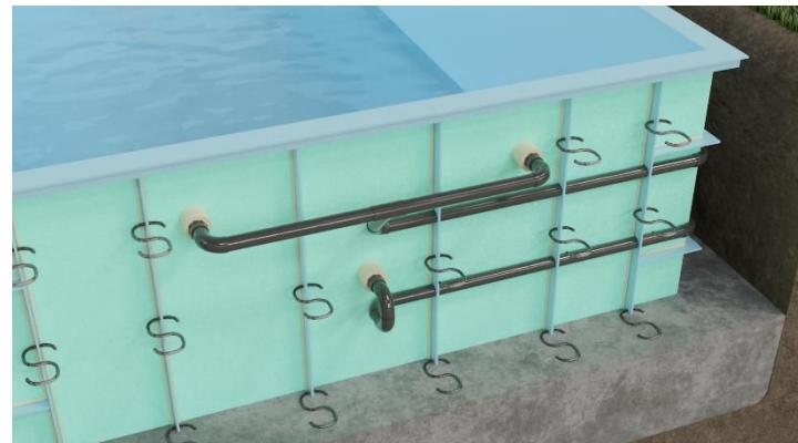
1. Bei Betonverfüllen soll der Wasserstand höher sein, als der Betonstand.
