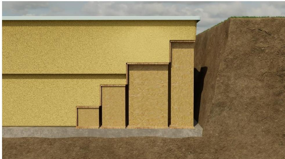
**Beim Befüllen des Zwischenraums zwischen Beckenwänden und Aushubwänden mit Beton ist es zu beachten, ob die Beckenwände ihre Form halten. Wenn die Wände:**
