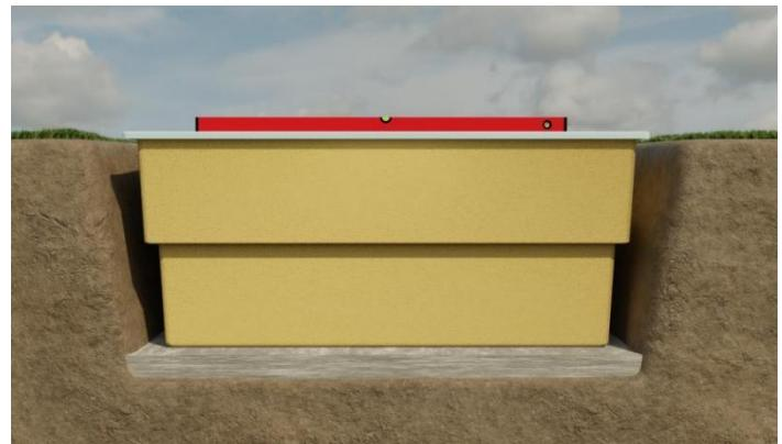
**Stellen Sie das Becken in die zuvor vorbereitete Baugrube. Überprüfen Sie nach der richtigen Einstellung die Höhe in Bezug auf die Ebene.**
